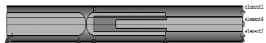
شکل (۶): پر شدن تمام فضای داخلی خط انتقال FL_2 توسط عایق (ساختار ۱).
