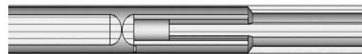
شکل (۲۴): ساختار ارائه شده برای کاهش میدان الکتریکی بین پوسته خط انتقال FL 2 و مغزی خط انتقال FL 3 .
