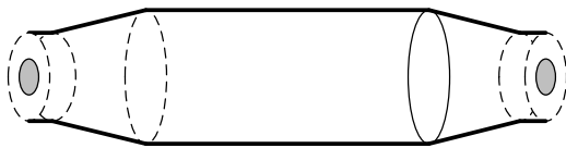
شکل (۲): افزایش قطر در محل اتصال مفصل
