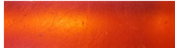
شکل (۱۰): ساختار بلوری سطح موجبر مسی خروجی لامپ سالم که تحت خطای برگشت توان قرار نگرفته است.
