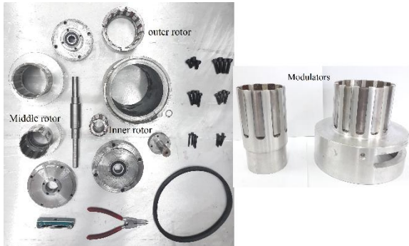
شکل (۱۴): قطعات تشکیل‌دهنده گیربکس مغناطیسی سه سرعت.
