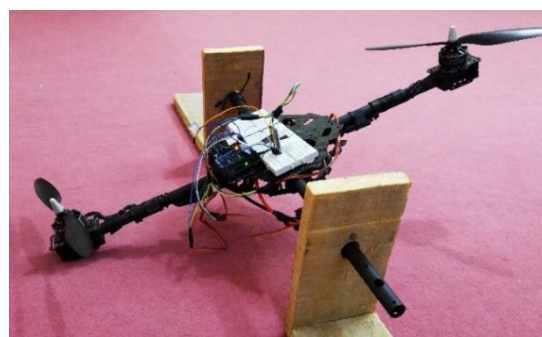
شکل ۹. نحوه قرارگیری ربات روی پایه با یک درجه آزادی
