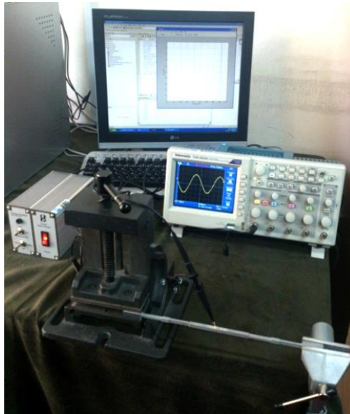
شکل ۹. مجموعه تجهیزات آزمون تجربی تعیین فرکانس طبیعی فلکسیچر
