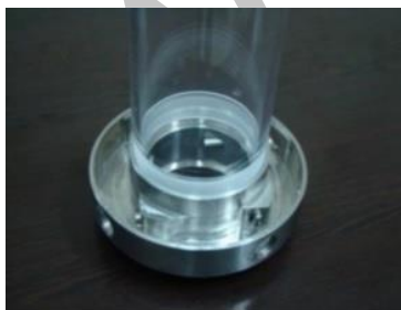
شکل ۲۲. نمایی از طرح محفظه به‌منظور تست سرد، (۷) کالکتور سیال، (۲) محفظه پلکسی‌گلس، (۳) انژکتور مماسی، (۴) پله تکیه‌گاهی، (۵) منفذ ورودی جهت تعویض انژکتورها، (۶) ورودی سیال
