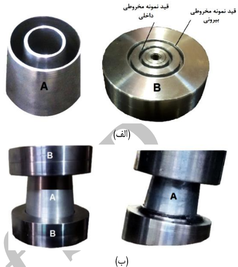
شکل ۱. نمای از الف) پوسته مخروطی دوجداره به همراه فیکسچر آزمایش، ب) شرایط مرزی گیردار محوری و زاویه‌دار
