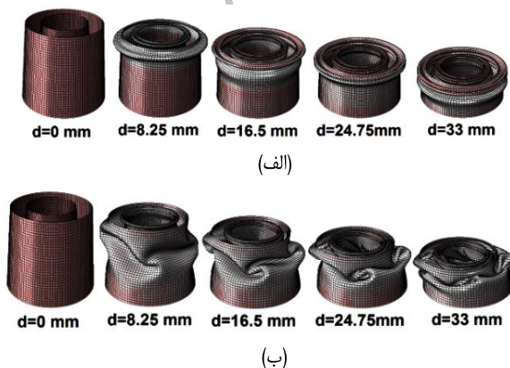
شکل ۹. شیوه فروریزش پوسته مخروطی دوجداره تحت شرایط مرزی دوسرگیردار؛ (الف) محوری، (ب) زاویه‌دار
