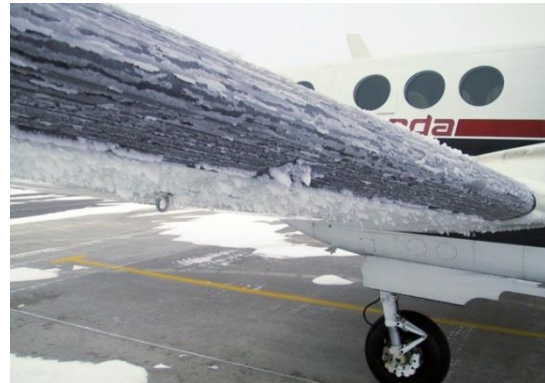
شکل ۳. تشکیل لایه یخ روی لبه حمله هواپیما [۲]
