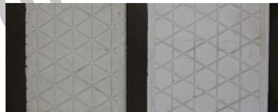
شکل ۱. قالب‌های منعطف شیاردار برای دو نوع شبکه شش‌ضلعی و مثلثی
