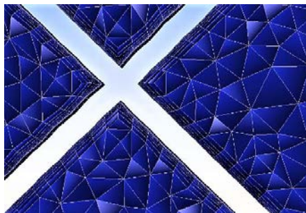
شکل ۴. شبکه لایه مرزی ایجاد شده در مجاورت بالک
