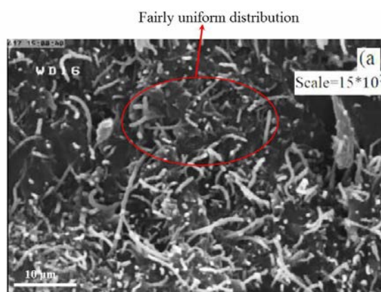
شکل ۸. تصویر سطح شکست نمونه‌ها با ۰/۲ درصد وزنی نانولوله کربنی برای (الف) اختلاط اولیه اپوکسی و نانولوله کربنی، (ب) اختلاط اولیه اپوکسی و سخت‌کننده
