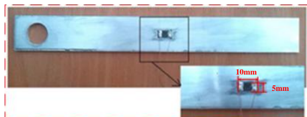
شکل ۱. تیر آلومینیومی و حسگر نانوماده مرکب چسبانده شده روی آن
