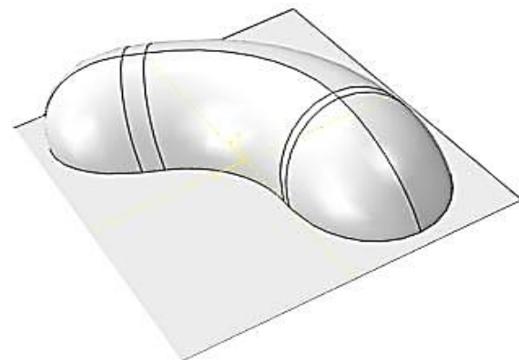
شکل ۴. مدل سنبه به صورت قطعه صلب سه‌بعدی
