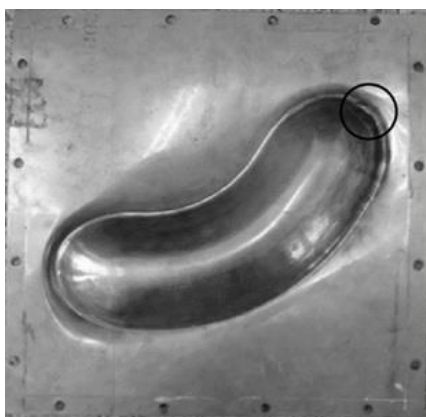
شکل ۲۰. آزمایش تجربی شکل‌دهی افزایشی ورق و پارگی رخ داده در گوشه بالای سمت راست
