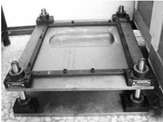
شکل ۸. تجهیزات بکار رفته در فرآیند فرم‌دهی افزایشی دو نقطه‌ای
