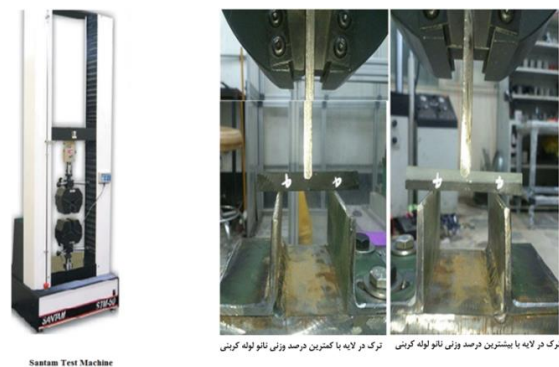
شکل ۲. دستگاه تست خمش سه نقطه‌ای.
