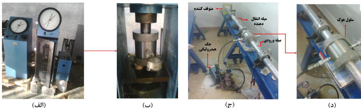
شکل ۱۲: بارگذاری شبه استاتیکی و دینامیکی با اعمال تنش محصورکننده با استفاده از سلول هوک (الف تا د)
