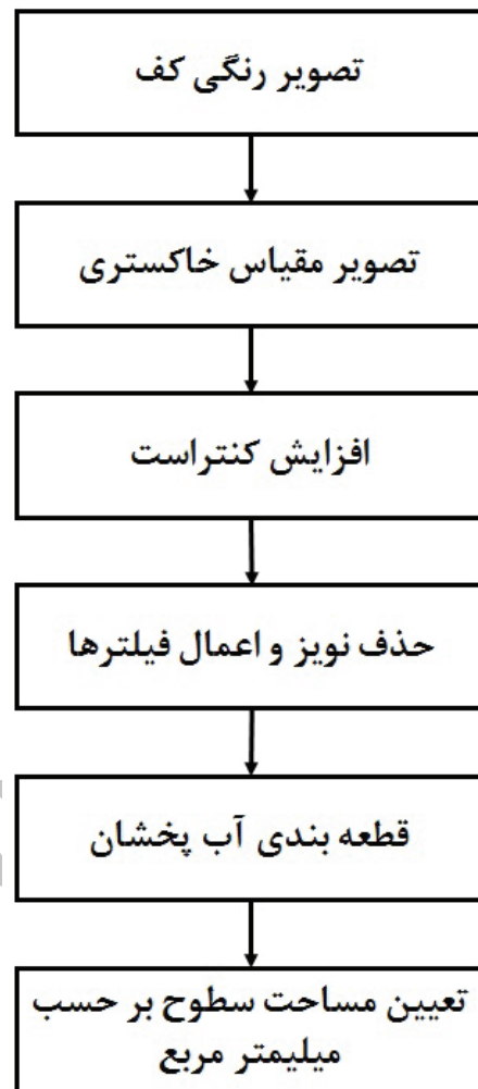
شکل ۹: روند تعیین ابعاد حباب کف با استفاده از روش آب‌پخشان
