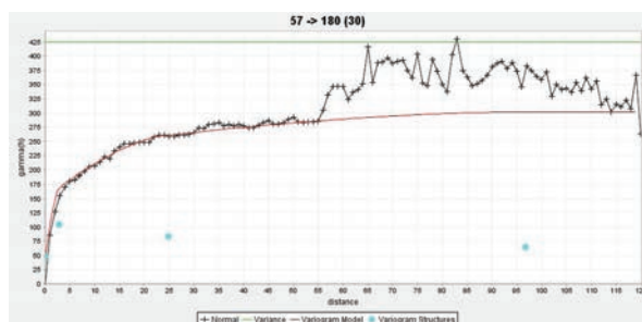
شکل ۸: مدل واریوگرام تجربی برازش شده چگالی درزه داری با گام یک متر
