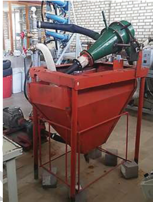
شکل ۱: نمای از سیکلون واسطه سنگین آزمایشگاهی
