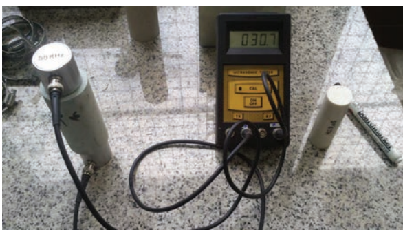
شکل ۵: نحوه قرارگیری ترانس دیوسرها روی نمونه
