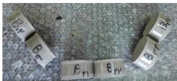
شکل ۷: نمونه‌های مناسب برای آزمایش برزلی
