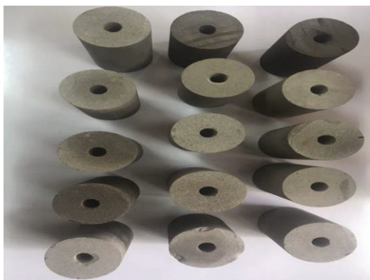
شکل ۲: نمونه‌های استوانه‌ای تو خالی آماده آزمایش
