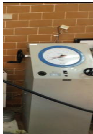
شکل ۸: پمپ اعمال فشار جانبی
