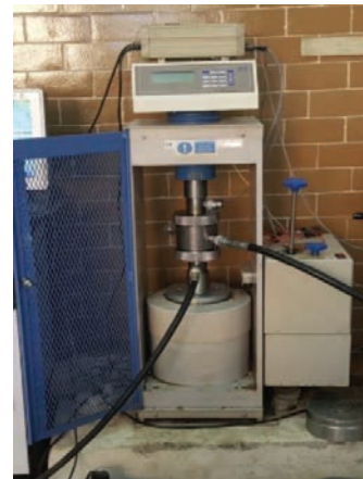
شکل ۱۱: دستگاه آزمایش در هنگام انجام آزمایش شکست هیدرولیکی
