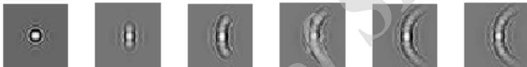
شکل ۸ فیلتر گابور کمانی به ازای طول های مختلف برای کمان به ترتیب از سمت چپ: 0, 0.1\pi, 0.2\pi, 0.3\pi, 0.4\pi, 0.5\pi .
