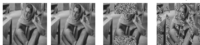
ث) استخراج نشانه شماره ۱ (ج) استخراج نشانه شماره ۲ (چ) بازسازی ۱ (ح) بازسازی ۲ PSNR=۳۶/۱۶ SSIM=۰/۸۸
