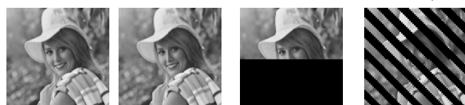
ث) استخراج نشانه شماره ۱ (ج) استخراج نشانه شماره ۲ (چ) بازسازی ۱ (ح) بازسازی ۲ PSNR=۳۴/۹۶ SSIM=۰/۸۱
