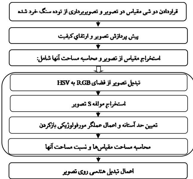
شکل ۲ روندنمای مراحل پیش پردازش، استخراج نشان گرها و رفع خطای پرسپکتیو تصویر دیجیتال قطعات سنگ خرد شده
