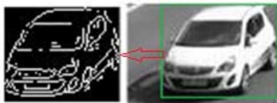
شکل ۱۱ تصویر سمت راست محدوده دقیق خودرو، تصویر سمت چپ تصویر لبه‌های خودرو بدون لبه‌های مزاحم
