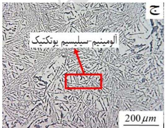
شکل ۶- ریزساختار مقاطع شعاعی استوانه ریخته‌گی از آلیاژ Al-20%Si در: (الف) لایه داخلی، (ب) لایه انتقالی و (ج) لایه خارجی.
