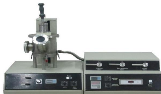
شکل ۱- کوره ذوب مجدد قوس الکتریکی تحت خلاء استفاده شده در این پژوهش.
