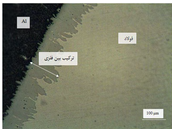
شکل ۲- تصویر میکروسکوپ نوری از نمونه‌ی غوطه‌ور شده در مذاب آلومینیم با دمای ۸۰۰ به مدت ۱۵ دقیقه
