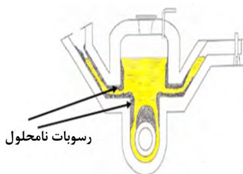
شکل ۱- تصویر نمادین از کوره‌ی ذوب‌ریز فشاری [۷].
