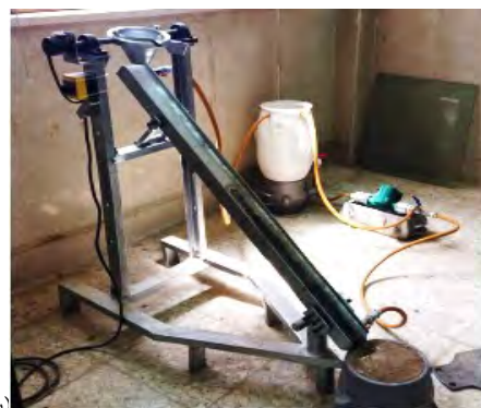
شکل ۲- (الف) شماتیک سطح شیب‌دار، (ب) دستگاه سطح شیب‌دار مورد استفاده و سیستم خنک‌کننده با سیال آب
