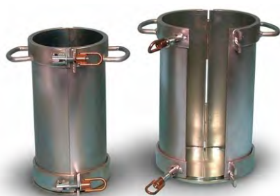
فرتور-۲- قالب پایایی به کار گرفته شده در آزمون‌های ریخته‌گری.
