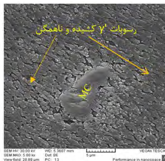
شکل ۲- تصویر SEM نمونه پس از ریخته‌گری.
