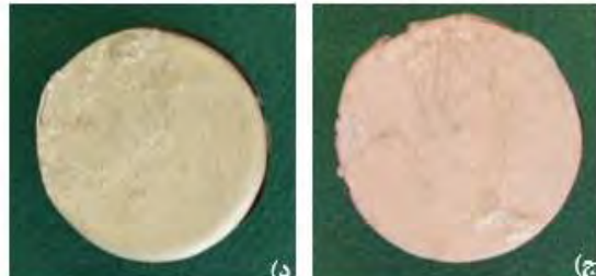
شکل ۲- سطح نمونه‌های ریخته‌گری شده: الف) AZ91، ب) AZ91+0.5%Ca، ج) AZ91+1.5%Ca، د) AZ91+2%Ca بدون حضور اتمسفر محافظ.
