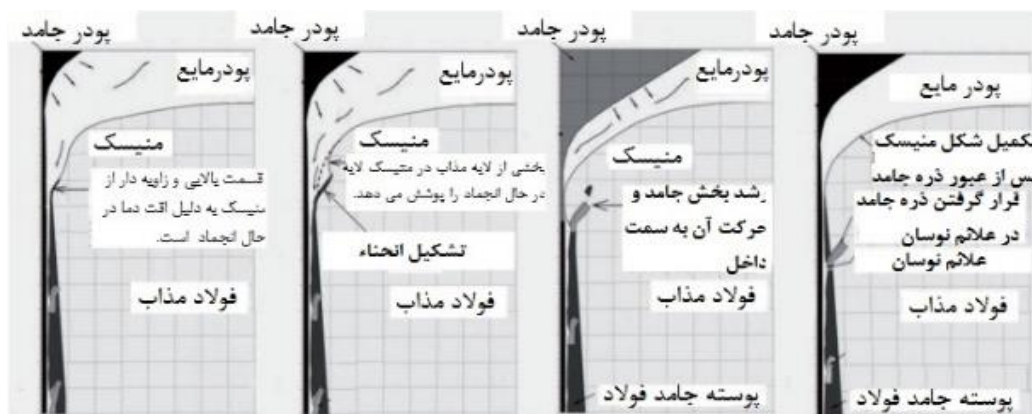
شکل ۵- مکانیزم ساده ایجاد علائم نوسان در سطوح شمش
