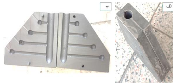
شکل ۳- قالب CRC برای اندازه‌گیری حساسیت به پارگی گرم: (الف) در حالت جفت شده، (ب) در حالت باز.
