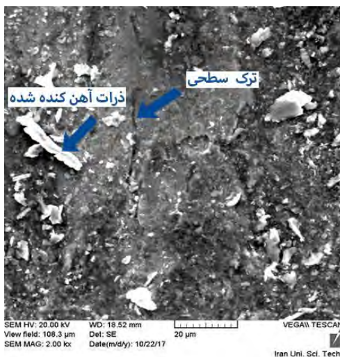
شکل ۸- تصاویر سطح سایش نمونه‌ی آستمبر شده تحت نیروی ۲۵ نیوتن (الف) تصویر الکترون برگشتی، (ب) تصویر الکترون ثانویه، (ج) آنالیز عنصری EDS
