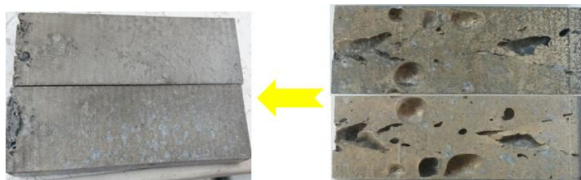
شکل ۴- تصاویر سطح نمونه‌ها، (الف) قبل از ریخته‌گری تحت فشار و (ب) بعد از ریخته‌گری تحت فشار
