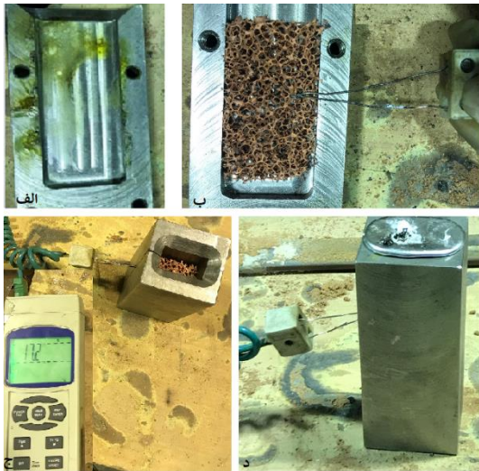
شکل ۲- نمایی از قالب فلزی طراحی شده برای ریخته‌گری: الف) قالب فلزی، ب) جایگذاری فوم سه‌بعدی سلول باز در قالب و نصب ترموکوپل، ج) مونتاژ قالب برای ذوب‌ریزی و ثبت دما با دیتالوگر، د) قطعه پس از ریخته‌گری زاماک ۵.
