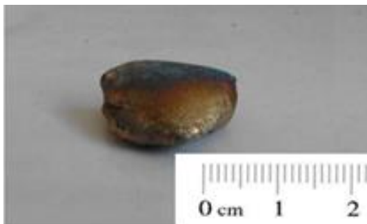
شکل ۱- نمونه تهیه شده به روش ذوب قوسی در خلاء.
