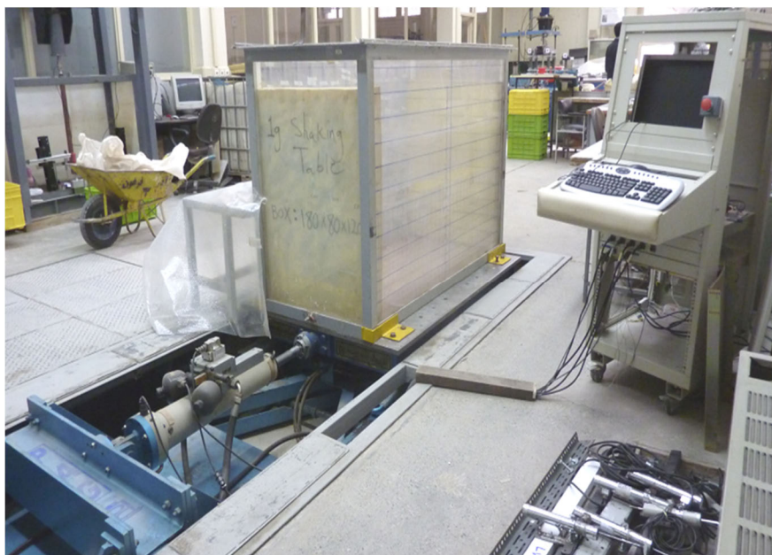
شکل (1): تصویری از میز لرزه دانشگاه تهران به همراه جعبه نصب شده بر روی آن
