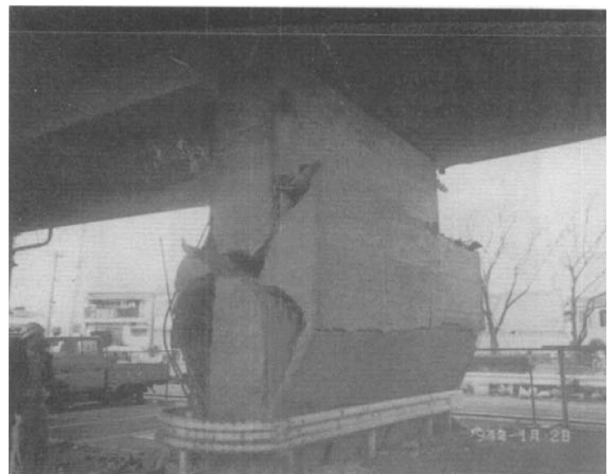
(ب) شکست فشاری پایه عریض شاهراه میشین [۶]
