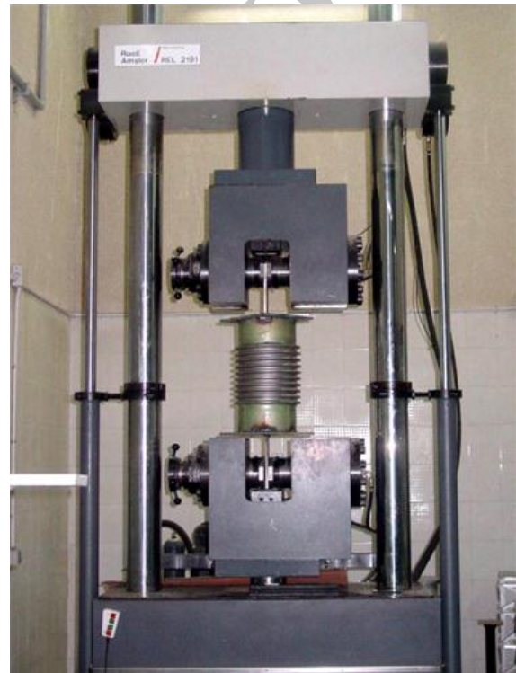
شکل (۲): نمونه‌ای از میراگر آکاردئونی در حال آزمایش [۲].
