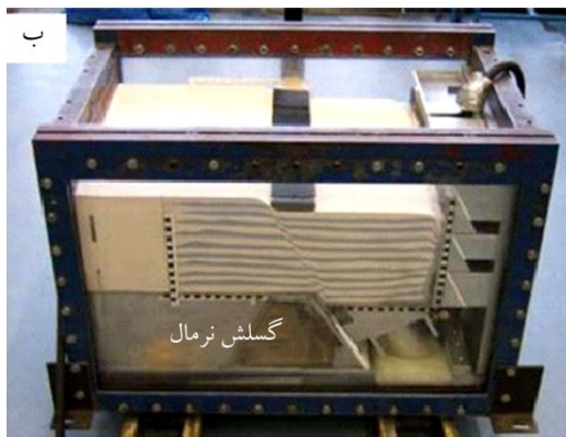
شکل (۳): جعبه آزمایش مدل سازی گسلش در دستگاه سانتریفیوژ دانشگاه داندی (الف) شکل شماتیک جعبه آزمایش؛ (ب) عکس از جعبه آزمایش [۳۹-۴۰].
