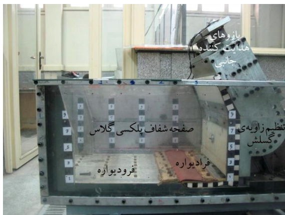
شکل (۵): جعبه آزمایش گسلش ساخته شده توسط آشتیانی و همکاران در دانشگاه تهران [۳۴].
