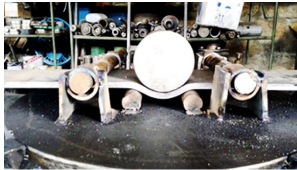
شکل (۱۳): ساخت بال نمونه RWS-F بر اساس نورد سرد.
