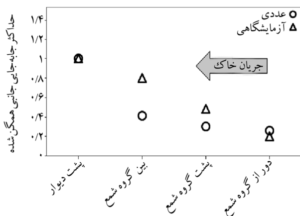
شکل (۱۱): توزیع حداکثر جابه‌جایی خاک سطحی همگن شده با جابه‌جایی خاک پشت دیوار در مدل آزمایشگاهی و عددی.
