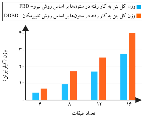
شکل (۱۶): مقایسه‌ی وزن کل آرماتور به کار رفته در ستون‌های هر دو روش نیرو و تغییر مکان.
