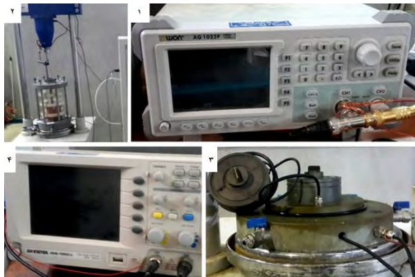
شکل (۱): (۱) دستگاه سازنده‌ی موج؛ (۲) دستگاه سه‌محوری دیجیتال همراه سلول سه‌محوری؛ (۳) مجموعه تیغه‌های دستگاه المان خمشی؛ (۴) دستگاه اوسیلوسکوپ.
