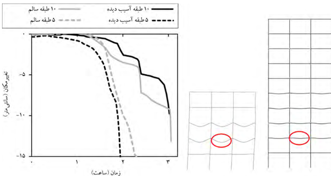
شکل (۱۵): نمودار تغییرات خیز تیر نمونه در قاب‌های خمشی متوسط تحت آتش استاندارد.
