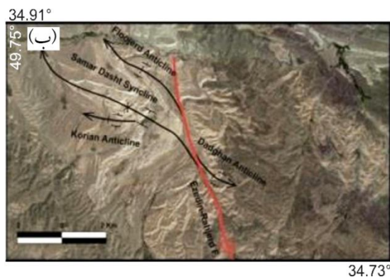
شکل (۸): الف) ناودیس عزالدین در پایانه شمالی و غرب گسله عزالدین- راهجرد و ب) ناودیس سردشت، تاقدیس‌های فلوجرد و کوریان در پایانه شمالی و غرب گسله عزالدین- راهجرد و تاقدیس دادغان در شرق گسله عزالدین- راهجرد. روند محور این چین‌ها در مواجهه با گسله عزالدین- راهجرد تغییر روند داده و با گسله موازی می‌شوند. موقعیت این چین‌ها بر روی شکل (۶) مشخص شده است.
