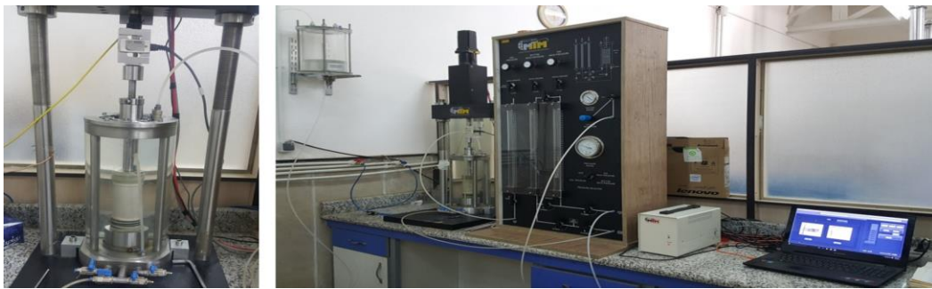
شکل (۲): شمای کلی دستگاه آزمایش سه محوری تناوبی و نمونه آزمایش.
