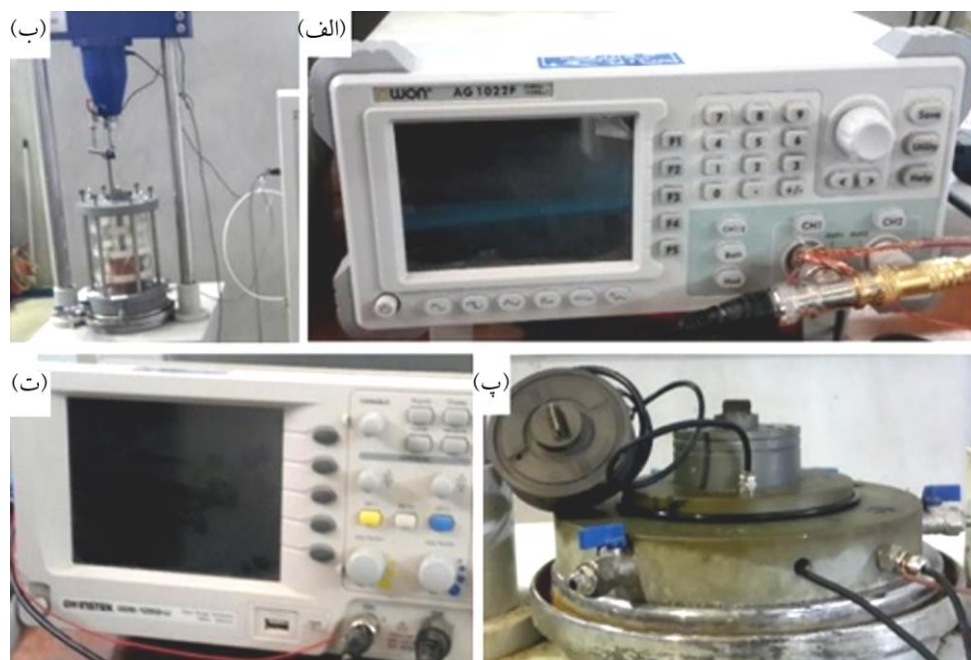
شکل (۱): (الف) دستگاه سازنده‌ی موج، (ب) دستگاه سه محوری دیجیتال همراه با سلول سه محوری، (پ) مجموعه‌ی تیغه‌های دستگاه المان خمشی و (ت) دستگاه اسیلوسکوپ.
